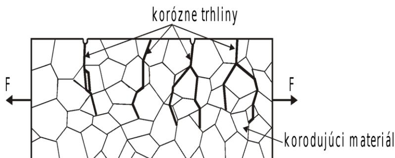
*Abbildung 7.3 Korrosionsrissebildung*
