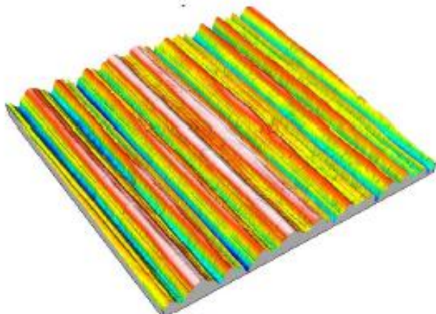
Obr. 6.14 Axonometrický spojitý obraz obrobeného povrchu [92]
