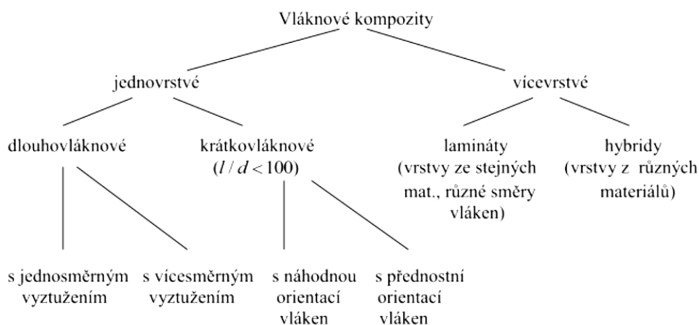
Obr. 2 Klasifikace vláknových kompozitů z geometrického pohledu [61]
