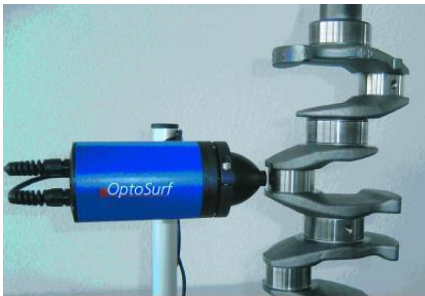
Obr. 6.8 Měření senzorem QS 500 [7]
