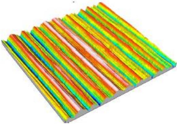
Abbildung 6.24 Axonometrisches kontinuierliches Bild der bearbeiteten Oberfläche[92].
