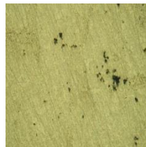
Obr. 32 pórovitosť 0,85 % p = 25 \text{ MPa}
