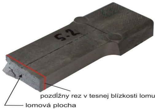
Obr. 18 Schéma odběru vzorku pro vyhodnocení pórovitosti testovací tyčinky
