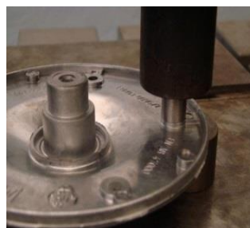
Obr. 12 Zatížení zkušebního místa odlitku
