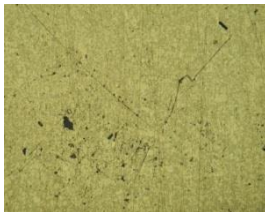
Obr. 30 pórovitosť 1,27 % v = 3,2 \text{ m.s-1}
