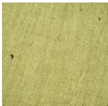
Obr. 29 pórovitosť 0,18 % v = 2,9 \text{ m.s-1}
